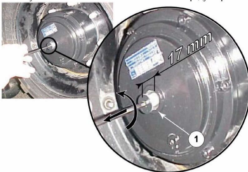
Рисунок 22. Отключение колес от колесных редукторов.
